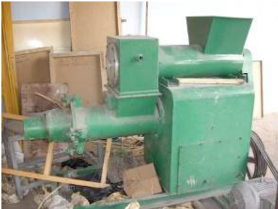
In Ecuador hergestellte Kopie eines Vakuum-Tonschneiders, dieser war nie funktionsfähig!
